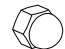
M10 Cap Nut (x4) Tuercas ciegas M10 (x4) Écrous borgnes M10 (x4)
